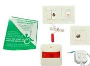
Sistema de señalización de emergencia para baños de minusválidos eficaz, simple de instalar y fácil de usar. En caso de emergencia el usuario sólo tiene que tirar de la cuerda, generándose una llamada a la zona de control de seguridad. Al generar la llamada, el sistema emite una advertencia audible y visual tanto en el área del baño como en la central. La llamada puede ser silenciada desde el baño pulsando el botón de cancelación, o desde la central. Elementos incluidos:
